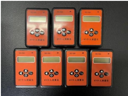
图 3-6 个人剂量报警仪
