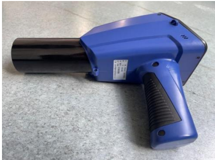
图 3-7 X-γ辐射监测仪
